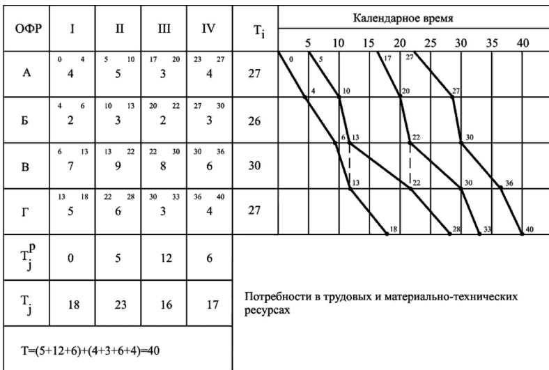
Рис. 10. Пример матричного календарного планирования по технологии МНОФ
