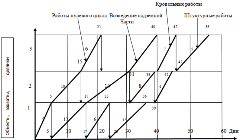
Рис. 6.1. Оптимизация операционно-технологического потока движения строительно-монтажного персонала при циклограммном календарном проектировании
