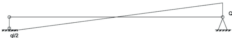
Рис. 7. Эпюра поперечных сил
