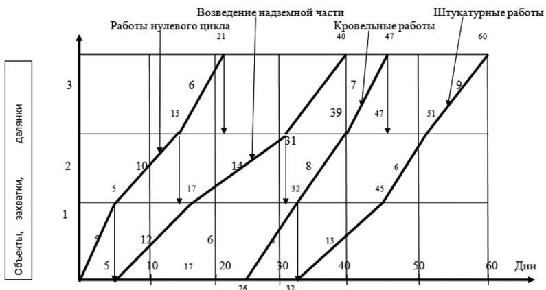
Рис. 6.2. Оптимизация операционно-технологического потока движения строительного персонала при циклограммном календарном проектировании – оптимизированный вариант
