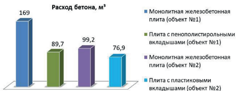
Рис. 3. Гистограмма расхода бетона по рассматриваемым конструкциям перекрытий
