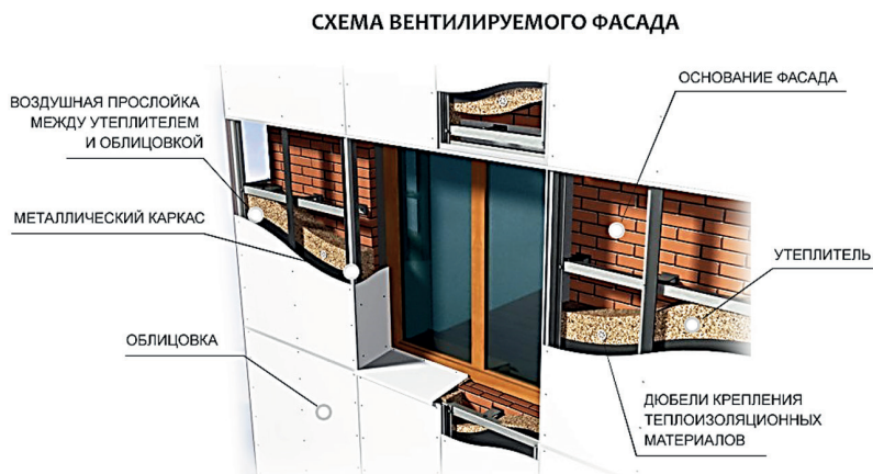
Рис. 4. Принципиальная схема устройства современного вентилируемого фасада
